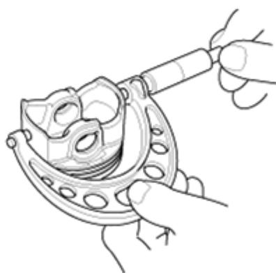
2. 在离裙部底端 14 mm (0.55 in) 处测量活塞裙部直径。
